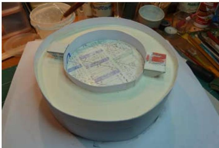
■ Plâtre en cours de prise dans un moule en carton dur / bristol avec empreintes des puits de lumière de l'embase.
