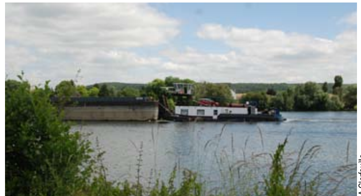
■ Vu de l'île aux frères : un pousseur sur le point de virer babord pour entrer dans le chenal des écluses, les remous provoqués érodent la berge du chemin de halage.
