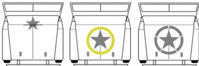
La « Unit Identification Marking » figure sur l'avant et sur l'arrière de chaque véhicule. Le marquage établi selon un code se trouve habituellement sur le pare-chocs ou à un endroit équivalent.
